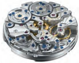
Ci-dessus et à gauche : Le calibre 380 Dual Wing de Jaeger-LeCoultre qui équipe le Duomètre à Chronographe. Les deux ressorts-moteurs s'arment à la main par la couronne, dans le sens horaire pour celui dédié au décompte du temps et anti-horaire pour celui du chronographe. L'étoile de la foudroyante est activée via la roue à colonnes.
