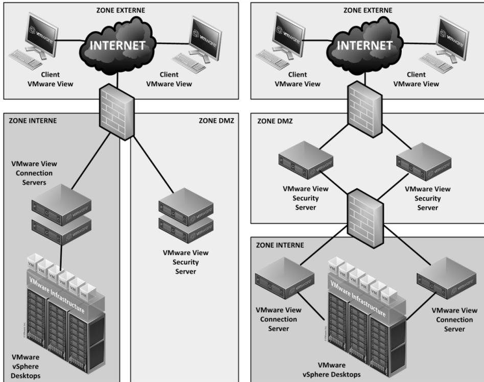
La configuration de gauche présente une DMZ avec un seul firewall ayant trois connexions réseau vers Internet (zone externe), vers le réseau interne ainsi que vers la zone DMZ. La configuration de droite est aussi composée de trois zones mais délimitées par deux firewall.
