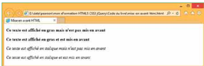
Figure 2.5 Visuellement, aucune différence entre b et strong ni entre i et em .
